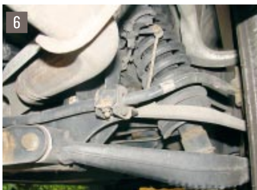
6 Feder-Bruch: Teure Reparatur, da nicht einzeln erhältlich.
