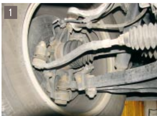
1 Kugel-Bolzen: Austausch nach durchschnittlich 50 000 km fällig.
