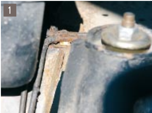
1 Zahn der Zeit – über Jahre extrem korrodierte Bremsleitungen.
