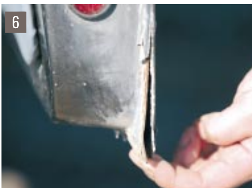
6 „Gefeilte Hecktüre“: Nach Jahren löst sich das Türblatt ab.
