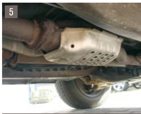
5 Nicht schön, aber zuverlässig: haltbare Auspuffanlage.
